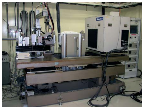
図1 BL38B1に導入されたタンパク質結晶構造解析用回折計
