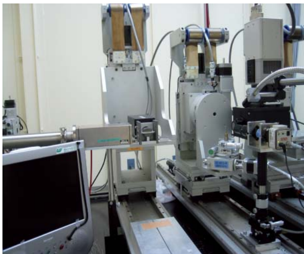
図2 BL20XU第一ハッチに設置されたマイクロCT装置
