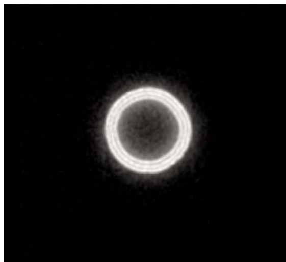
図3 BL20XU第一ハッチに設置されたマイクロCTによるテスト試料のCT像測定例。 Cu-Al 同心円多層膜 線幅 2 \mu m、X線エネルギー20keV、 投影画像素サイズ0.52 \mu m/pixel、投影数750 projections/180deg.
