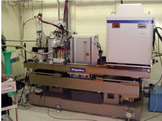
図1 構造ゲノムビームライン実験ステーション内部の様子 遠隔操作可能な実験ステージ上に、ゴニオメータ、サンプルチェンジャー、2種類の2次元検出器が設置されている。
