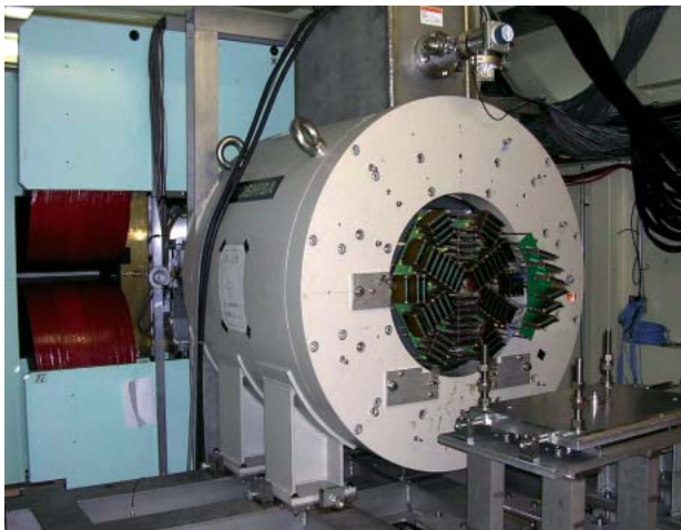
図1 BL33LEP実験ハッチ内に設置された超伝導ソレノイド電磁石とTPC検出器。後方に見えるのが双極電磁石スペクトロメーターである。
