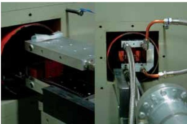
図1 ビーム照射用ステージ ビームダンプ外へ取り出した状態(左)とビームダンプ内に挿入した状態(右)
