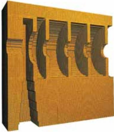
図8 加速管用電界結合型RFカップラのモデル
