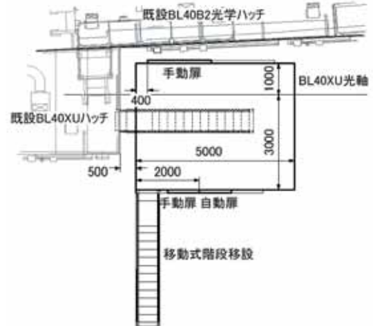
図1 ピンポイント構造計測専用ハッチ図面
