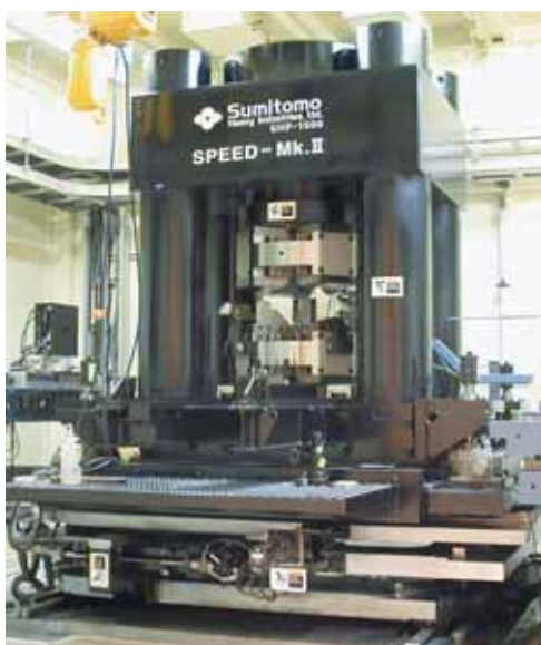
図1 高温高压発生装置SPEED-Mk.
