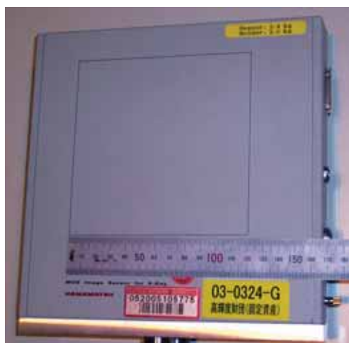
図4 フラットパネルセンサC7942-02の写真。四角い黒の枠内が受光面である。
