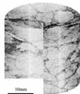
図3 三次元再構成した蛍石のセクショントポグラフィ像（444回折、60keV）。 コントラストの暗い部分は回折強度が高いことを示す。検出器はビームモニタとCCDカメラを組み合わせた物を使用した。亜粒界の3次元構造が観察できる。
