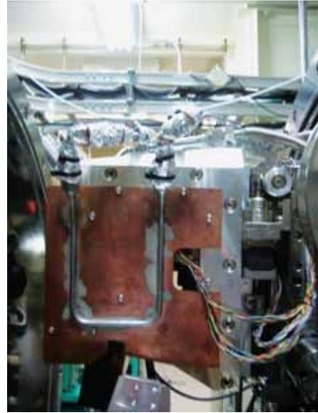
図2 第2結晶クレイドルに取り付けたコンプトンシールド。シールドの冷却水は第2結晶の冷却水流路より分岐させている。
