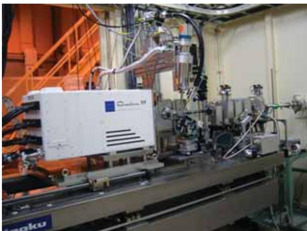
図4 新設されたX線CCD検出器Quantum 315 (ADSC社)
