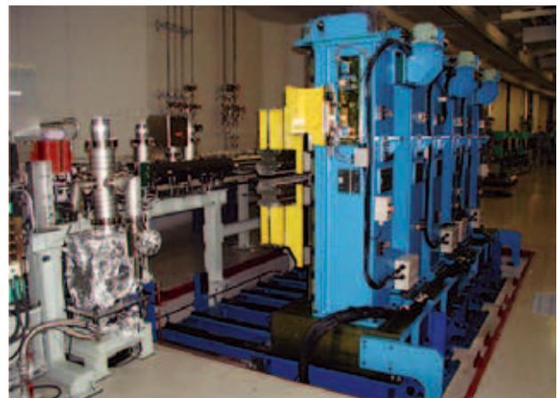
図18 加速器診断Ⅱ挿入型光源装置。電子ビーム軸に挿入された状態（上）と、電子ビーム軸から退避させた状態（下）を示す。
