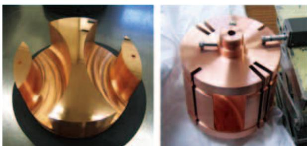
図3 接合前のロータ半割および完成したロータ
