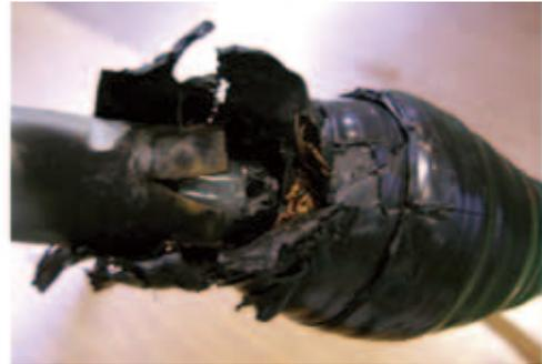
図7 放電した部分の拡大写真。銅線の部分はアース線部で陰極の高電圧部とこのアース線の間で放電が発生した。
