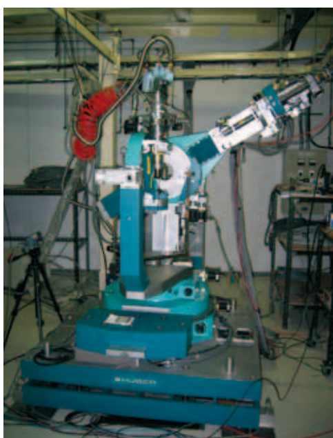
図1 4K冷凍機を導入した多軸回折計の様子
