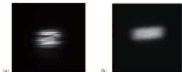
図2 18.6keVにおける(a)水冷ダイヤモンドモノクロメータから(b)液体窒素冷却シリコンモノクロメータからのビームプロファイル
