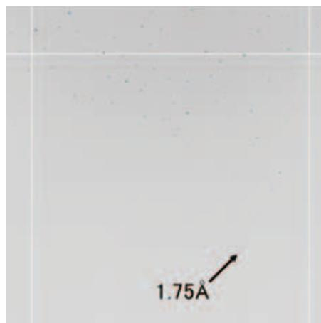
図7 撮影された回折イメージ(高分解能領域の一部を拡大したもの)。矢印の部分が $1.75\text{\AA}$ 分解能。
