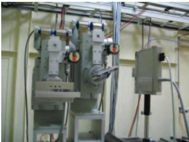
図3 ビームの縦方向拡大のための非対称反射光学系。画面中央にSi結晶が配置され、その後方(右側)には大面積検出器であるフラットパネル検出器が配置されている。このフラットパネル検出器により、ビームを照射しながらの結晶アライメントが可能になった。
