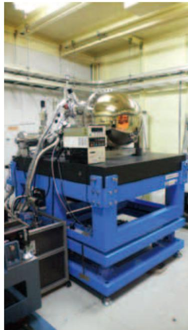
図8 硬X線顕微光電子分光装置（常設型）
