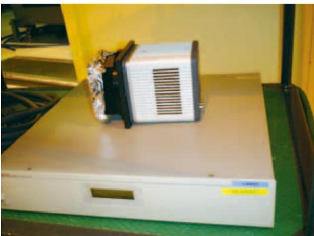
図1 4000画素冷却CCDカメラ
