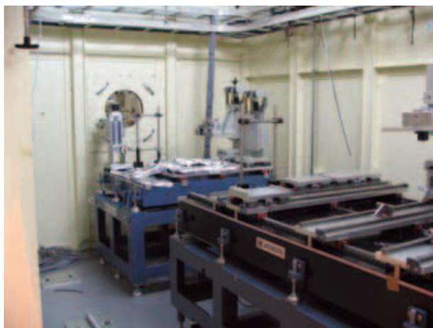
図5 メディカルバイオトライアルユースに対応するために導入された定盤(画面奥)。試料ステージ・検出器ステージおよびアナライザー用ステージから構成される。
