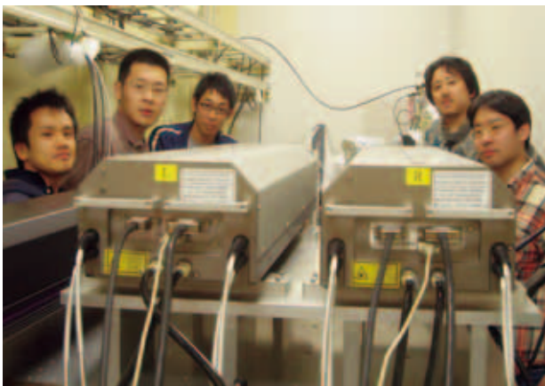
図1 BL33LEPレーザーハッチ内に設置された2台の新モードロック・レーザー
