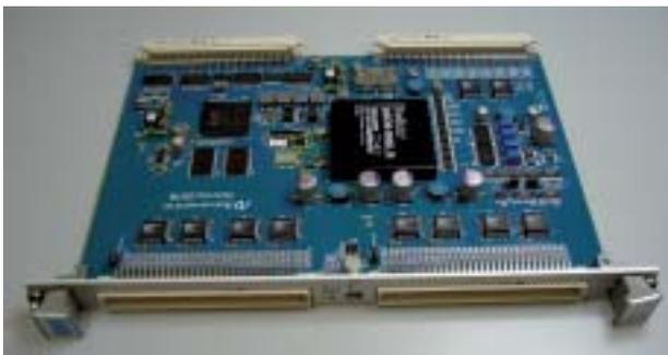
図1 VMEbus対応ADCボード
