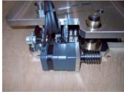
図9 遠隔Tilt調整機構駆動部。中央部がステッピングモータ、上部が調整台でありこの上にバンパ電磁石を乗せる。ビーム進行方向は向かって右から左である。実機では、ステッピングモータの後ろに回転測定用エンコーダを取り付けた。
