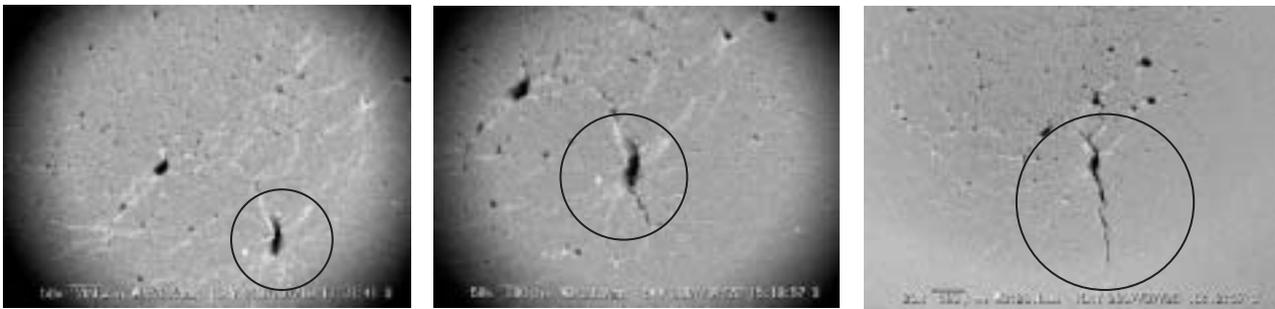
図3 吸収熱量600Wにおける試験片中心部でのSEM写真 (左: 300回照射後倍率 $\times 50$ 、中央: 350回照射後倍率 $\times 50$ 、右: 400回照射後倍率 $\times 20$ )
