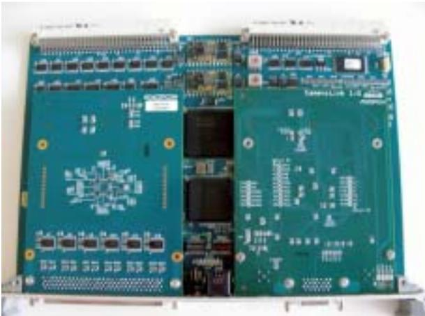
図3 汎用ロジックボード。CameraLink対応I/Oボード搭載
