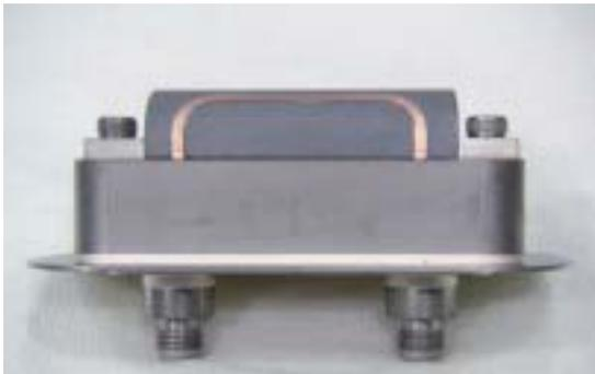
図5 パルス・タイミング計測専用のモニター
