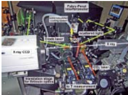
図3. X線回折・ブリルアン散乱・レーザー加熱複合同時測定装置(写真)。
