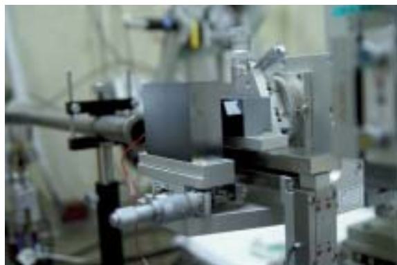
図3 ^{149}\text{Sm} 用高分解能モノクロメータ
