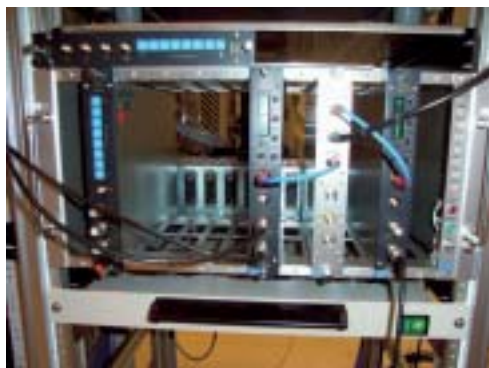
図5 時分割X線分光用機器モジュール。周波数同期型16ビットカウンター (左) とその他モジュール一式 (右)。
