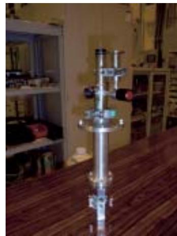
図2 ヘリウムフロー型冷凍機(Oxford Instruments社製)。ラディエーション・シールド及びシュラウドは用途に応じて設計・変更可能である。写真は、レーザー光導入可能な可視光透明窓を有するシュラウドが取り付けられた状態である。
