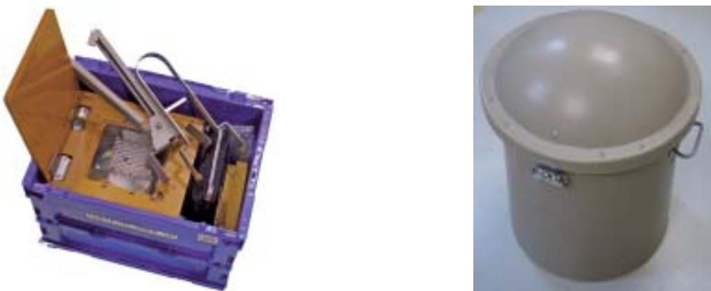
図3 (a) メールインデータ測定用マウントツールキット、(b) 凍結試料輸送用ドライシッパー
