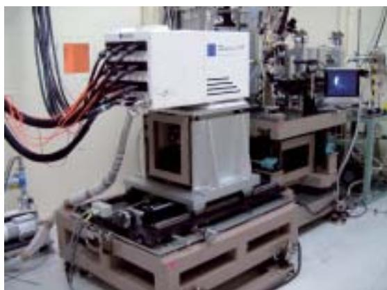
図2 新回折装置架台。
