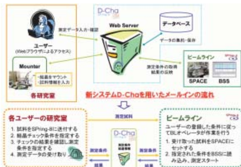
図2 WebデータベースD-Chaを用いたメールインデータ測定。D-Chaは試料情報、測定条件、回折データなどの情報を保存するデータベースである。ユーザーの研究室からはインターネットを通じて、また、ビームラインからはLANを通じて情報のやり取りを行う。D-Chaが研究室とビームラインのインターフェースとしての役割を果たすことで、メールインデータ測定が可能となる。
