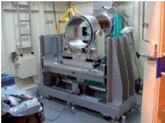
図1. BL20B2実験ハッチ2に設置された大型Zステージ。X線望遠鏡のハウジングを搭載した状態。
