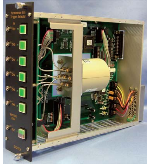
図4 高耐久リレーを使用した新しいガントリガー用トリガーセレクター (17K93)
