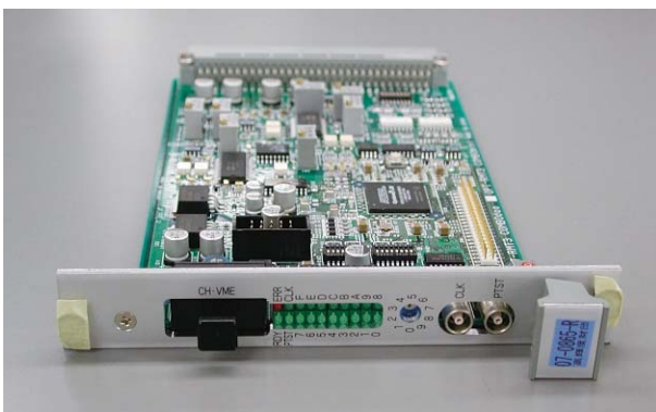
図3 開発したOPT-RMT COMBOdao ボード。FPGAを交換することでOPT-RMT COMBOminiボードとしても機能ようになる。
