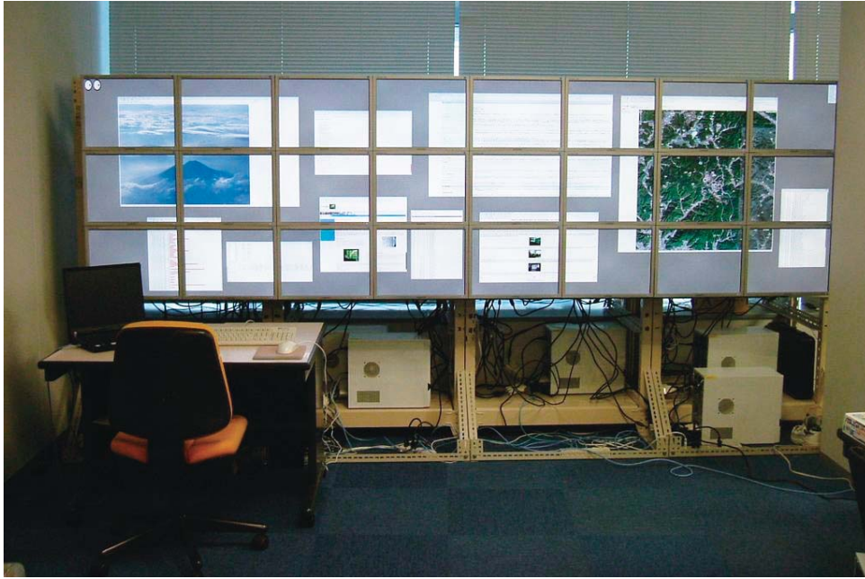
図1 21インチ液晶ディスプレイ 24台から構成されるディスプレイウォール試作機の稼働の様子
