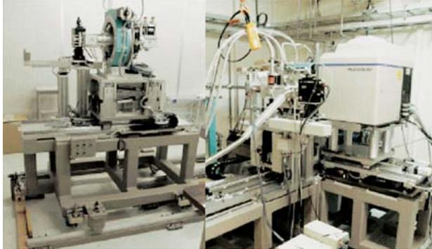
図2 低温・高圧実験用クライオスタットとX線回折・ラマン散乱同時測定用ゴニオメータ（右；BL10XU実験ハッチ1に装備された状態）
