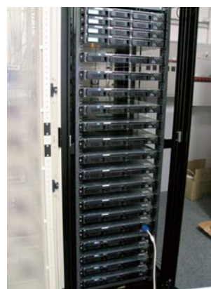
図4 理研および共用BL共通のタンパク質結晶構造解析用小規模クラスタ
