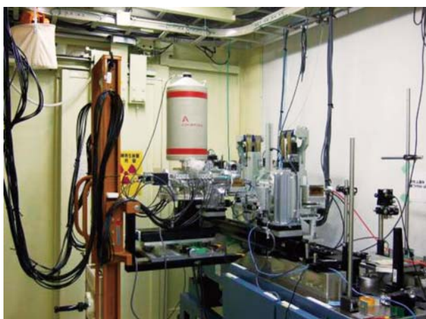
図5 BL16B2に導入された19素子SSD検出器および新規XAFS実験架台
