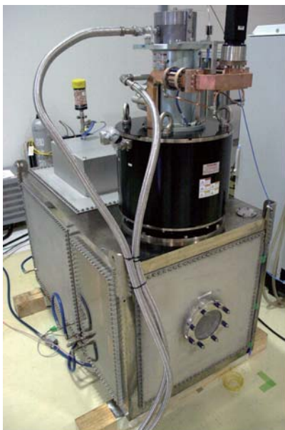
図6 一体型モジュレータ電源（外観）
