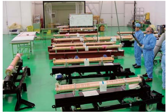
図5 Cバンド加速管の量産（於三菱重工2008年2月）
