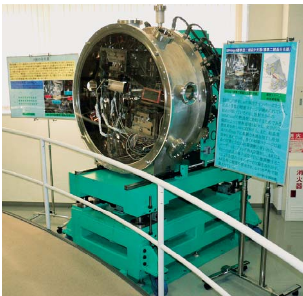
図3 展示室に設置されたSPring-8標準型2結晶分光器
