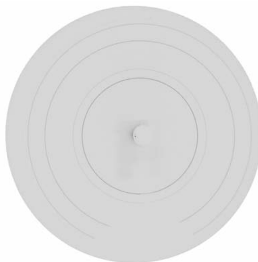
図2 大型X線CCDカメラによる回折パターン（ \text{CeO}_2 ）
