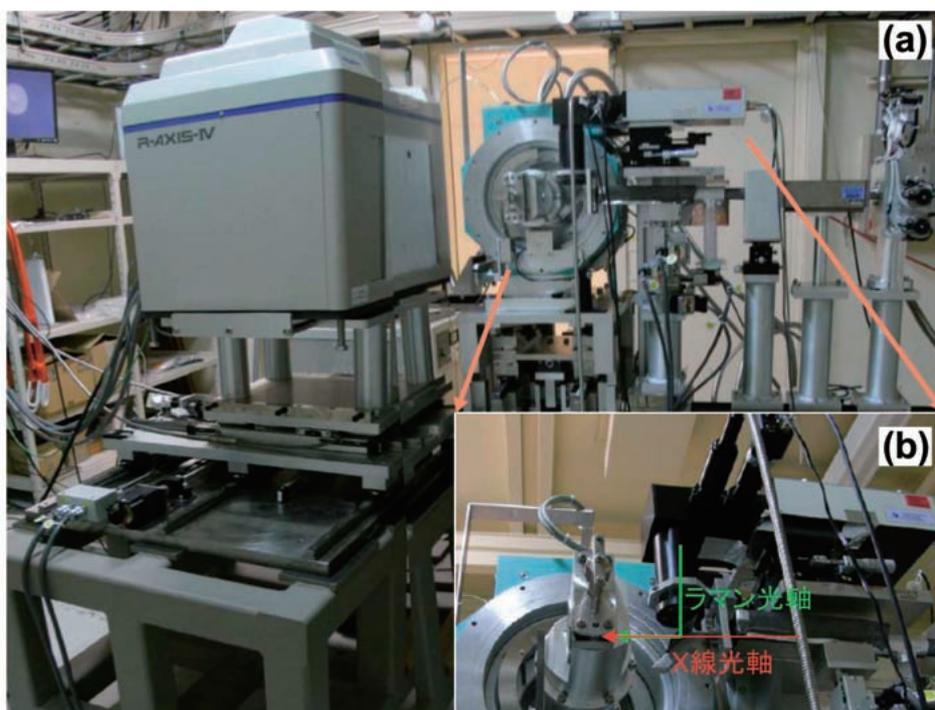
図1 BL10XUに完成した高圧低温X線回折・ラマン散乱同時測定実験装置 (a) とそのラマン散乱光学系部分拡大写真 (b)
