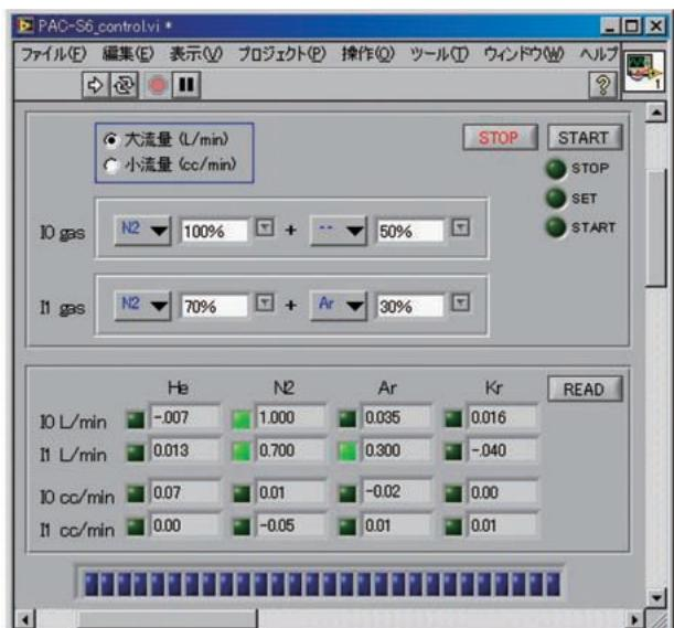
図2 イオンチャンバー用ガス設定外部制御プログラム
