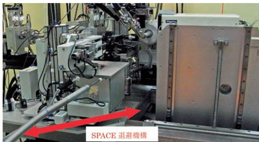
図1 サンプルチェンジャーSPACEが上流側へ退避する退避機構の導入
