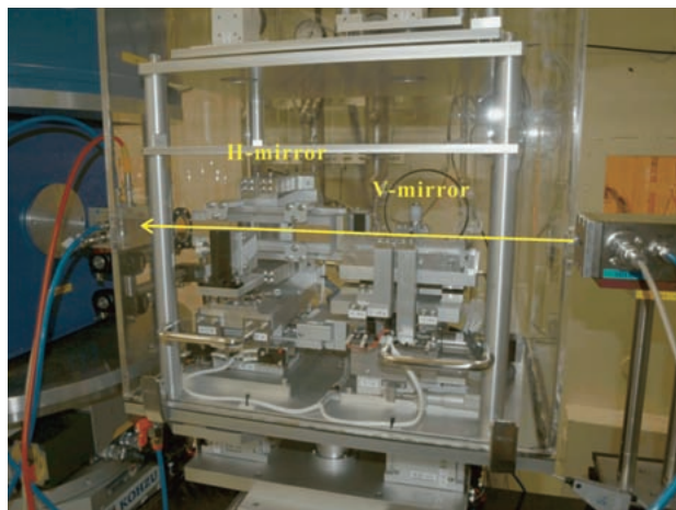
図2 BL39XU実験ハッチ内最上流に設置された、高圧下X線磁気分光用X線集光ミラーユニット。
