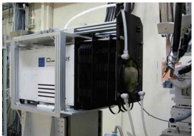
図4 カメラ長自動追従型Heチャンバー（神津精機製）
