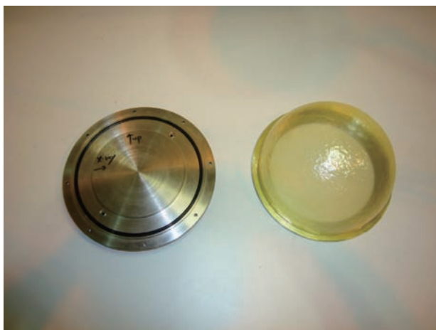
図4 取り付け方法を改良したATX-GSOR用カプトンドーム
