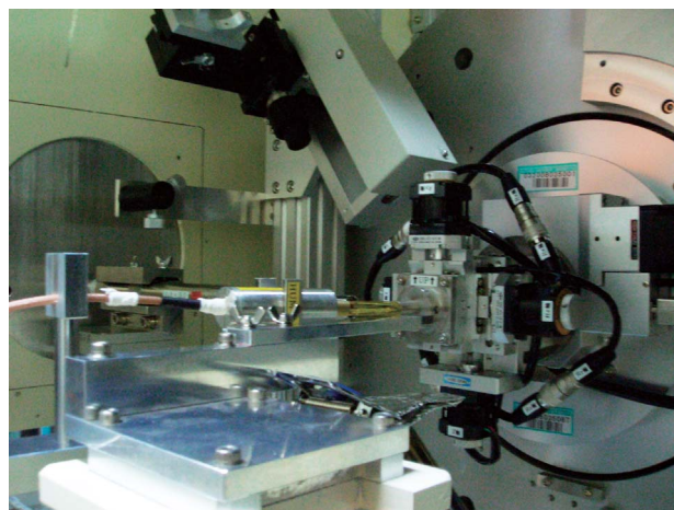
図5 湿度制御（HUM-1使用）実験時の試料周辺設定（課題番号2009B206）。UV感光性ポリイミド製の平板状試料ホルダーと湿度吹き付け部を新規に整備した。試料ホルダーの試料導入部は幅0.3 mm、長さ4 mmおよび深さ0.05～0.10 mmである。
