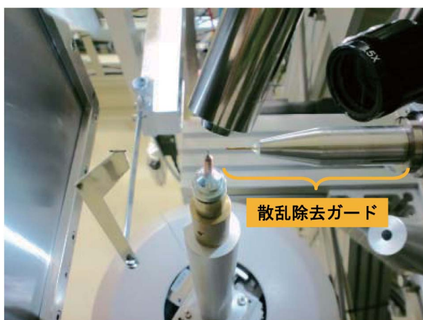
図2 ピンホールスリットに追加された散乱除去ガード。ピンホール部にキャップするように被せて取付ける。ピンホール自体はパイプ先端から12 mm、試料から16 mmの位置に存在している。
