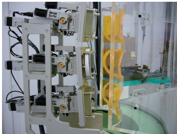
図5 非弾性散乱分光器に新たに設置されたマルチアナライザーシステム
