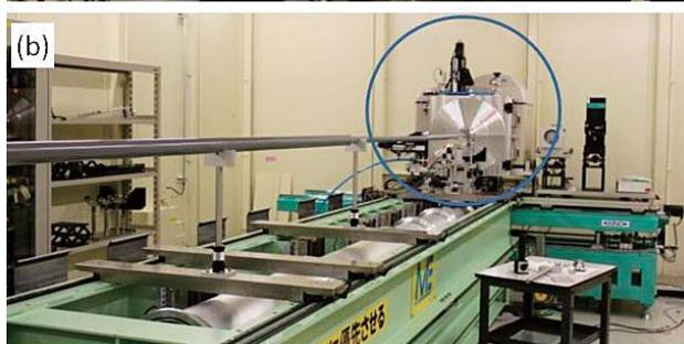
図2 カメラ距離0.25 mの広角散乱測定レイアウト。(a) 拡大図、(b) 架台全体像、青丸の部分が (a) である。
