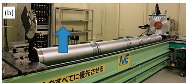
図3 カメラ距離4.1 mの小角・広角散乱同時測定レイアウト。
