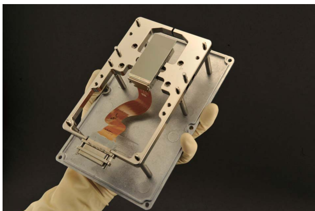
図13 MPCCDセンサー (左) と組み立て中のMPCCD検出器と実験のイメージ (右)。試料に当たって回折されたX線はセンサーによって検出される。入射X線と極小角の散乱X線は検出器の中央部の穴によって下流側に導かれ、下流に設置されるもう一組の検出器で検出される。
