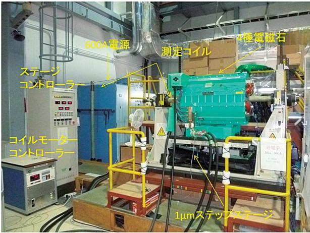
図4 ハーモニックコイル磁場測定器に電磁石を据え付けた様子
