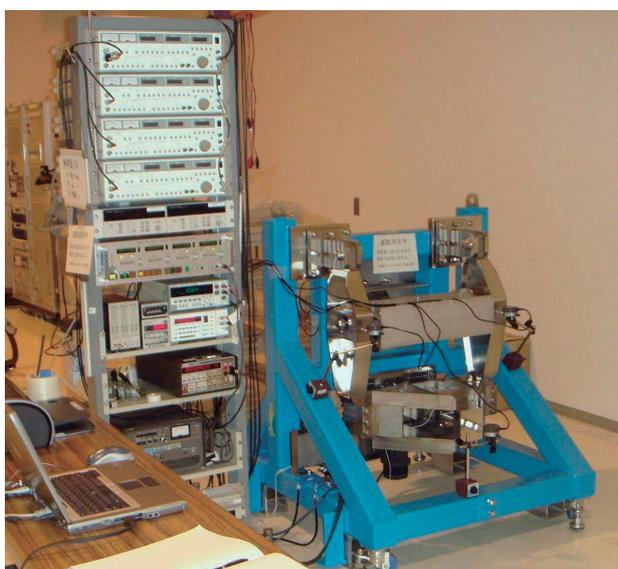
図12 高剛性チューナ (青色の架台に取付) の動作試験
