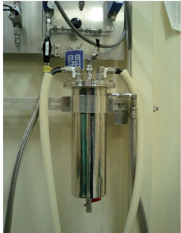
図3 ガス供給除害設備向けの水蒸気除去用冷却トラップ
