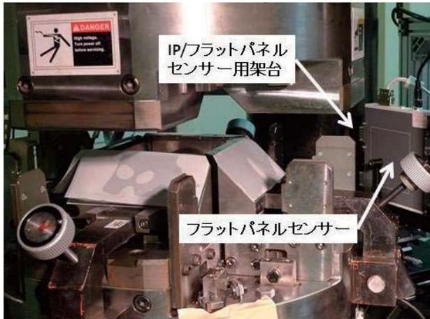
図3 IP/フラットパネルセンサーホルダーの設置状況
