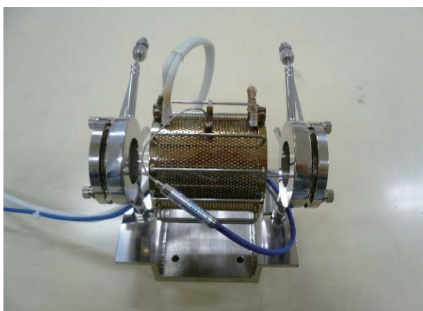
図4 石英製透過法用高温セル
