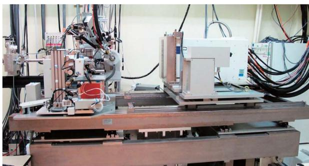
図2 IPステージ上に取り付けたCCD検出器用のステージとQuantum 315
