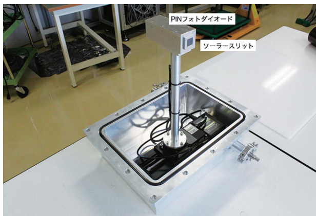
図2. 試料位置調整のために真空バス内にセットされているソーラースリットとPINフォトダイオード。
