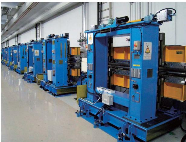
図1 SPring-8蓄積リング内に設置された8台の水平／垂直偏光型8の字アンジュレータ
