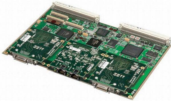
図4 開発したFMC汎用ロジックボード。写真では3枚のFMCカード（CameraLinkカード2枚とSerDesカード1枚）を実装している。
