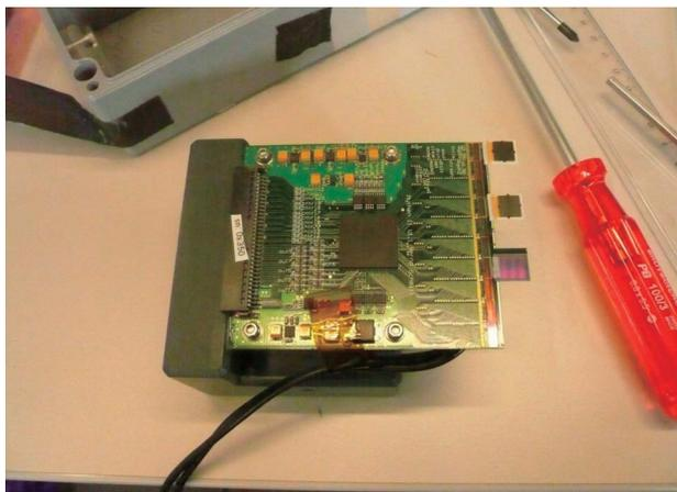
図3 オーミック型CdTeセンサー、Inショットキー型CdTeセンサー及びリファレンスとしてシリコンセンサーを接合した試験用MYTHEN検出器。
