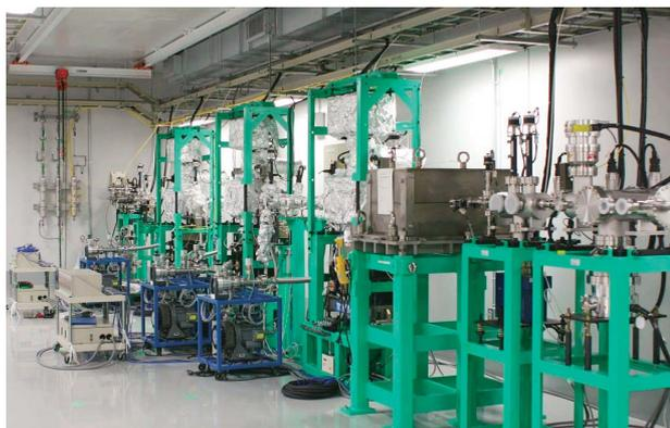
図10 光学ハッチ内にインストールされたビームライン光学系・輸送系コンポーネント
