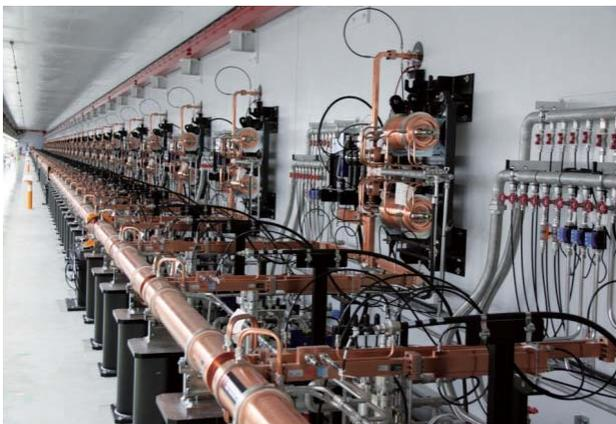
図4 トンネル内にCバンド加速器が並ぶ光景。
